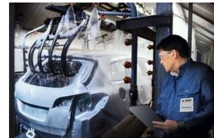
Prétraitement avant revêtement sur voiture électrique NIO (Chemetall)
