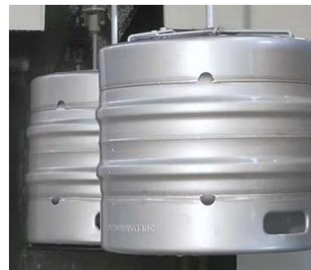
Fûts de bière décapés sans acide nitrique (Envasas Técnicos Zaragoza S.L. Entinox, ES)
