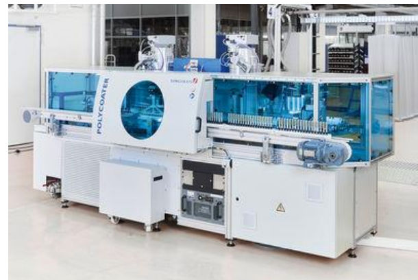
Machine de chrome optique sous vide de Singulus Technologies AG
