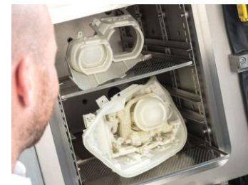
Chambre de process du FKM de 700 x 380 x 580 mm
