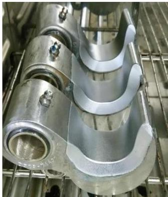
Crochets de porte d'avion Airbus en inox 15-5-PH, chromage de la partie interne (30  $\mu\text{m}$ )
