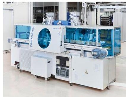
Machine de chrome optique sous vide de Singulus Technologies AG
