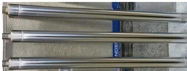
Tiges d'amortisseurs avec PSA et Renault (épaisseur de 15 à 20  $\mu\text{m}$ )
