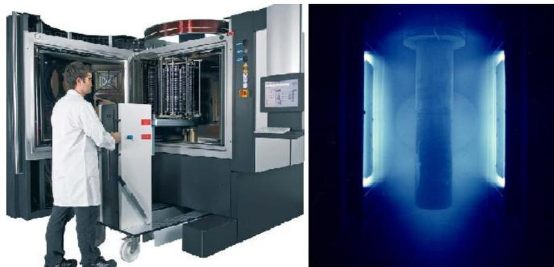
Les différentes techniques sont classées en 3 catégories : évaporation sous vide, pulvérisation cathodique, dépôt ionique. Les dépôts les plus répandus sont des dépôts d'aluminium ou oxyde d'aluminium, de chrome sur plastique, dépôt d'or, d'argent, dépôts de nitrure, de carbure...
