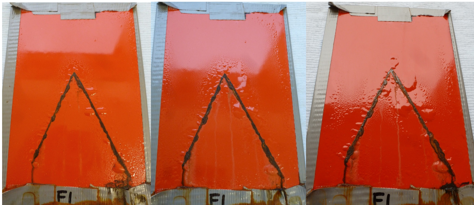
Série 2 : Evolution 240h – 400h – 500h en brouillards salins neutres
