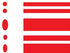
Causes : Buse usagée ou partiellement bouchée.
