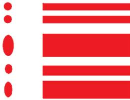
Buse abimée : *remplacer la buse*
