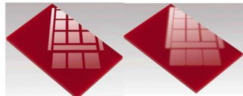
Trop de solvants légers ne permet pas d'assurer une tension de film suffisante (effet de blush)
