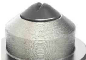
A l'arrière de la buse, se trouve le siège, qui permet son immobilisation. Le matériau du siège est choisi en fonction du degré d'abrasivité du produit mis en œuvre. Il peut être en plastique, en inox ou en carbure
