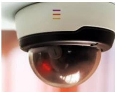
Image 18 : Exemple de caméra fixe permettant une thermographie permanente
